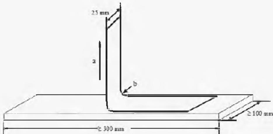
a – направление усилия отрыва, b – угол отрыва
